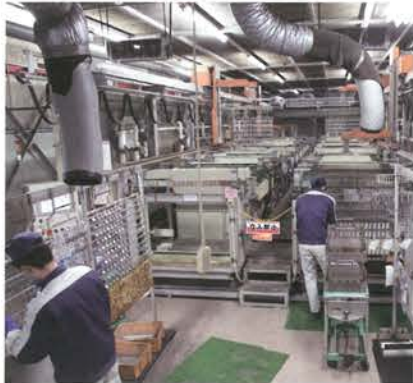
▲ 日本初にして唯一のニッケルすずめつき自動加工ライン
